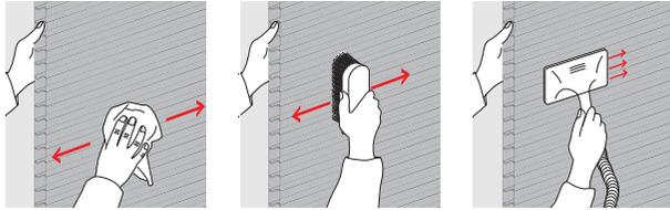
Abwischen mit antistatischem Tuch, abbürsten mit Staubwedel oder weicher Bürste bzw. absaugen mit schwach eingestelltem Staubsauger.
